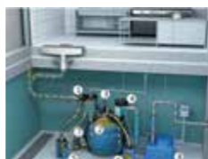
▲ OK系列油水分离器工作原理
