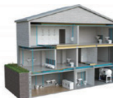
▲ 真空排水系统
